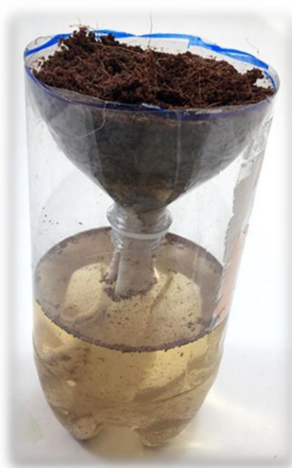
სურათი 6. ჰიდროპონიკის კონტეინერი, რომლის წყლის რეზერვუარი ავსებულია.
